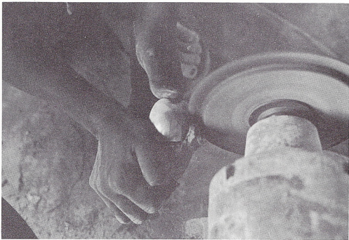
รูปที่ 11 ตัดเปลือกหอยมุกเพื่อเอาเฉพาะส่วนที่จะนำมาใช้งานได้
