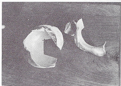
รูปที่ 11 ตัดเปลือกหอยมุกเพื่อเอาเฉพาะส่วนที่จะนำมาใช้งานได้
