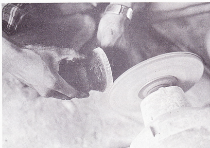
รูปที่ 19 เมื่อแห้งดีแล้วนำไปขัดให้ผิวหน้าเรียบ เสมอกันจะเห็นลายประดับมุกด้วยเครื่องเซาะระโน
