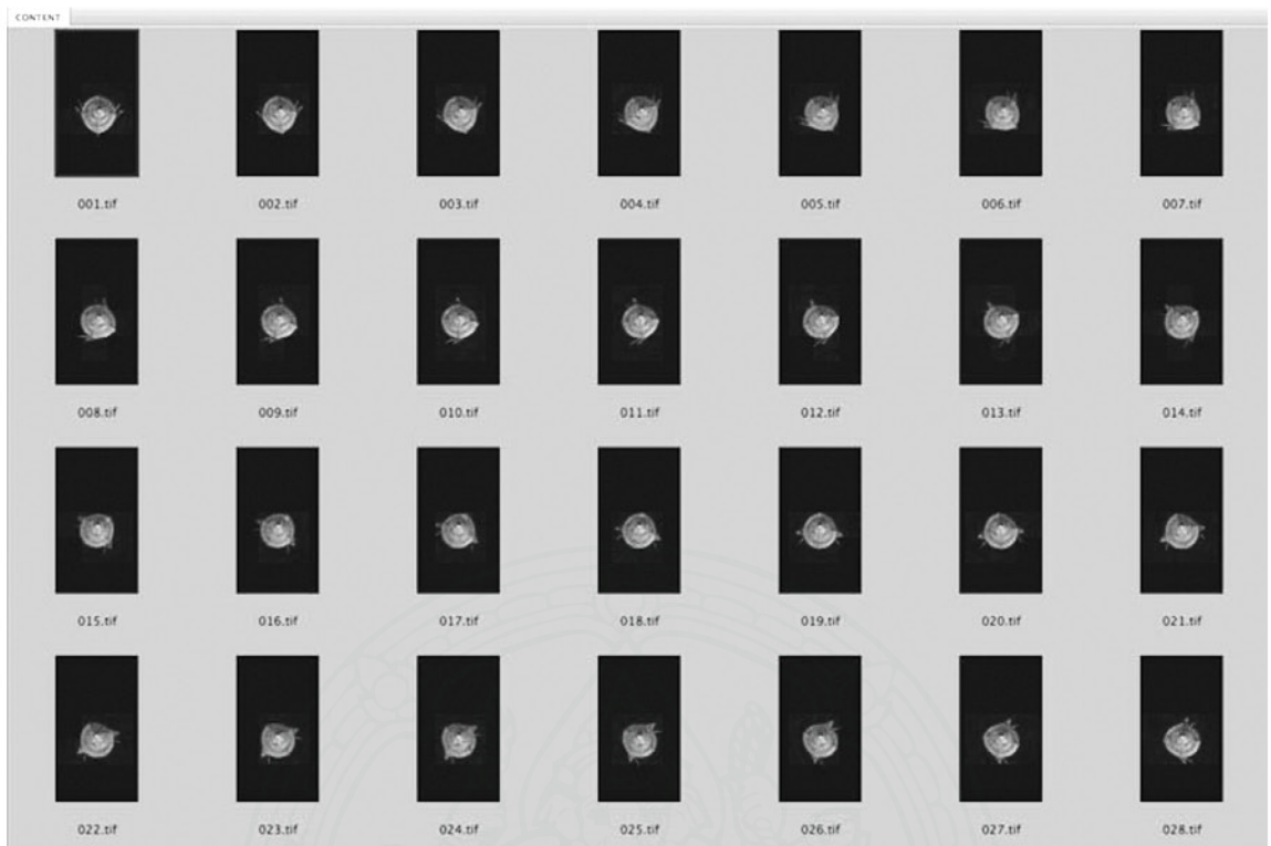
เริ่มการบันทึก ภาพโดยตั้งกล้องที่ตำแหน่ง ๙๐ องศา ของวัตถุ และ หมุนวัตถุ ทีละ ๑๐ องศา โดยรอบ
