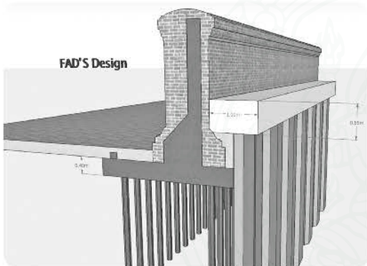
แบบของกรมศิลปากร ซึ่ง WMF เห็นชอบและเสนอให้มีการทดสอบกำลังรับน้ำหนักของเสาเข็ม และฝังฐานรากให้ลึกมากขึ้น
