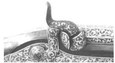
นกสับแบบแคปสล็อต หรือเพอร์คัสชันสล็อต
