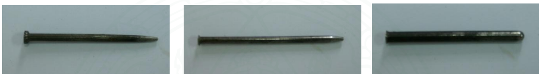
ภาพ ๔.๒ ก ภาพสั้วหุ้มน(สั้วหุ้มสาก) ขนาดเล็ก กลาง ใหญ่
