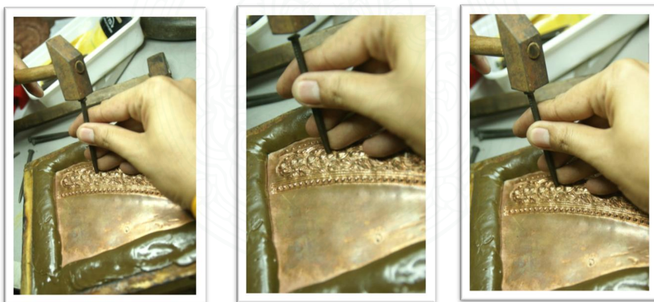
ภาพการปรับเหล็กลมมุมบนชิ้นงานส่วนบนสุด เพื่อให้เกิดระยะและสวยงามเพิ่มมากขึ้น
