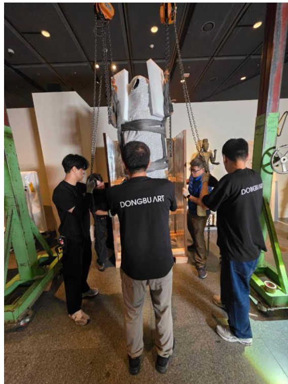
การตรวจสอบสภาพโบราณวัตถุขนาดใหญ่ และการเคลื่อนย้ายโบราณวัตถุ ด้วยสลิงอ่อน หรือสลิงแบน (Webbing Sling) และใช้ A Frame Crane หรือ Hand Stacker ในการยกหรือเคลื่อนย้าย
