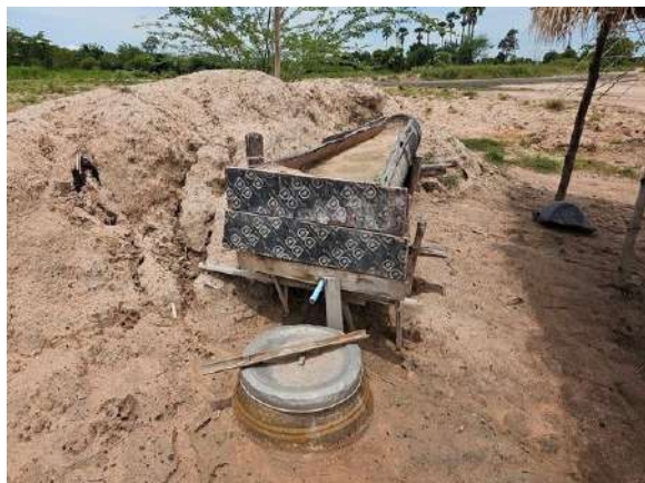
ภาพที่ 2.9 ตัวอย่างการผลิตเกลือสินเธาว์ในพื้นที่ตำบลพันดุง อำเภอขามทะเลสอ จะนำดินที่มีเกลือมาใส่ไว้ในรางต้นตาลโดนด ก่อนจะเทน้ำ ลงไปเพื่อให้ น้ำเกลือและน้ำไปต้มในกระบวนกรสุดท้าย
