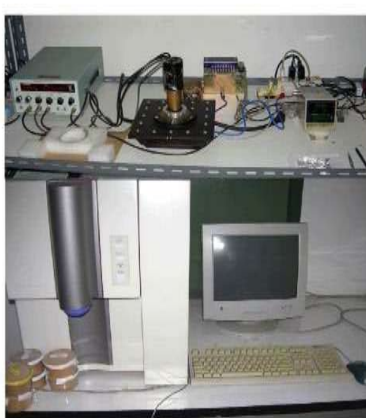
รูปที่ 1.4 เครื่อง Thermoluminescence Detector (TLD) ที่ใช้ในการกำหนดอายุ โดยความร่วมมือ พัฒนาร่วมกันระหว่างภาควิชาวิทยาศาสตร์พื้นพิภพ คณะวิทยาศาสตร์ มหาวิทยาลัยเกษตรศาสตร์ และมหาวิทยาลัยยะคีตะ ประเทศญี่ปุ่น
