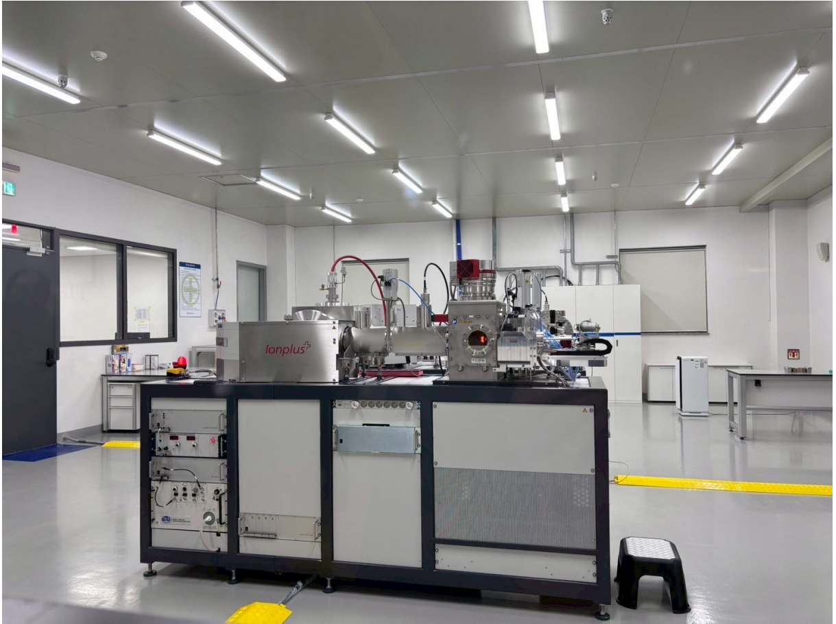
รูปที่ ๓๒ เครื่อง Accelerator Mass Spectrometer (AMS) สำหรับวิเคราะห์ตรวจอายุตัวอย่างโบราณคดีโดยวิธีหาค่าคาร์บอน -๑๔
