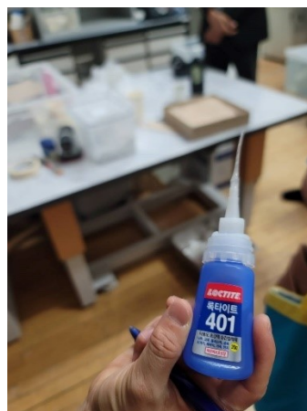
รูปที่ ๑๐-๑๑ เครื่องฉายรังสียูวีที่ช่วยให้มองเห็นร่องรอยการซ่อมเดิมบนวัตถุและกาวยาที่เหมาะสมกับการซ่อมติดชิ้นส่วนดินเผาหรือเซรามิกส์
