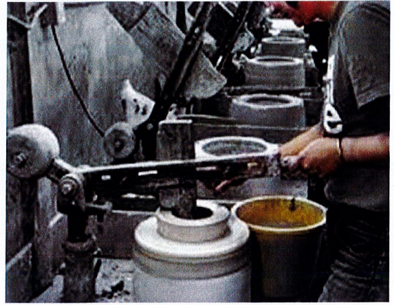
ภาพการขึ้นรูปด้วยใบมีดแบบภายใน ที่มาภาพ : http://www.cerawan.com/15282641/ปูนในงานขึ้นรูปแบบจิ๊กเกอร์
