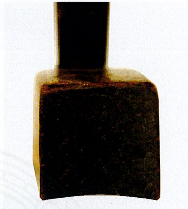
หน้ากบด้านสกัดของกบต่องโอนคว่ำ สามารถใช้ชิ้นงานให้เป็นลักษณะหลังเต่าได้
