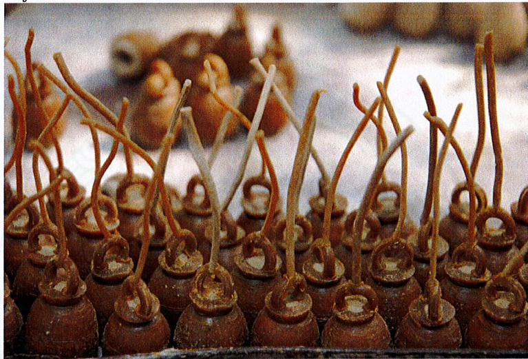
หุ่นขี้ผึ้งกระดิ่งที่ติดหุและขนวนเสร็จเรียบร้อยแล้ว
