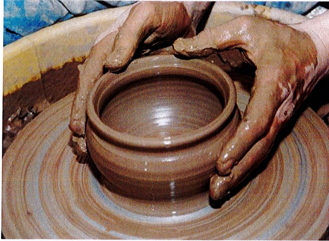
ภาพการกลึงแต่งรูปทรงตามแบบที่ต้องการ ที่มาภาพ : http://mymorningboost.com/wp-content/uploads/2015/12/pottery-wheel.jpg
