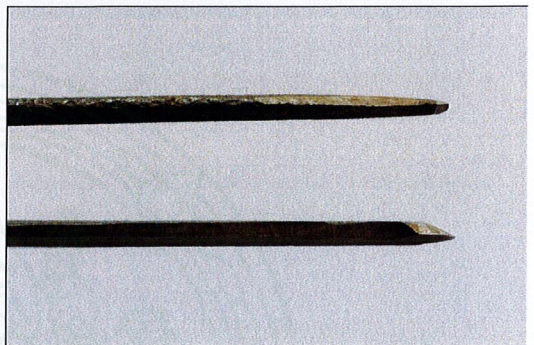
ส่วหน้าโค้ง (ด้านหน้า) และ ส่วหน้าโค้ง (ด้านข้าง) สำหรับขวานภายใน (อุปกรณ์ของช่างกลึง สำนักช่างสิบหมู่)
