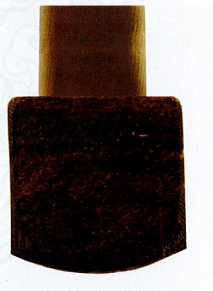
หน้ากบด้านสกัดของกบต่องโอนหงาย สามารถใช้ไสชิ้นไม้เป็นลักษณะรางที่มีขนาดใหญ่ กว่าคิ้วบัวเล็ก ๆ ได้
