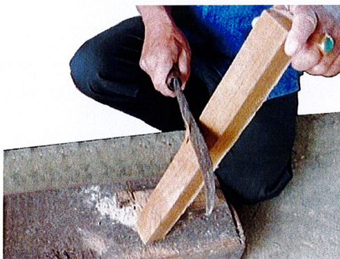
การลบเหลี่ยมไม้ด้วยมีด
