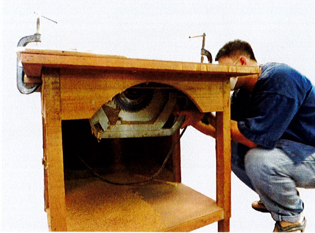
การปรับแต่งความสูงของคมเลื่อยในการเลื่อยคั่ว
