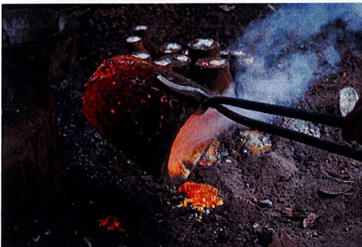
การหลอมโลหะและเทน้ำโลหะหรือการเททอง
