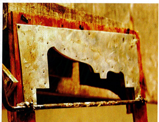
ตอกผนึกให้แน่นติดกันระหว่างแผ่นอะลูมิเนียมกับแผ่นไม้อัดประกบ
