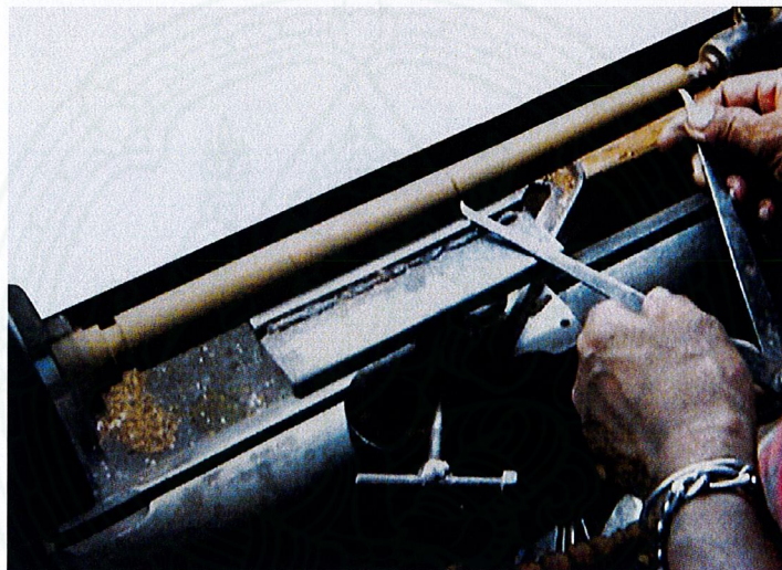
ใช้เขาควยวัดขนาดจากแบบกระดาชแต่ละช่วงกำหนดขนาดความกว้างของแต่ละช่วงของหุ่นขึ้นงาน ๓
