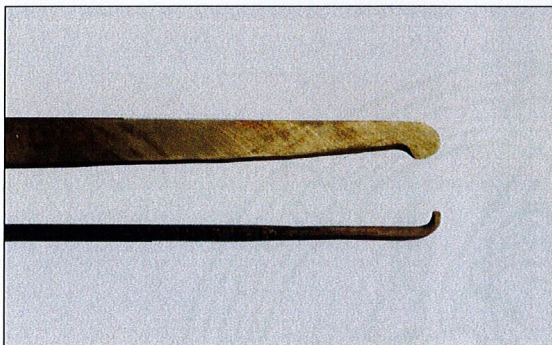
ส่วหน้าโค้ง (ด้านหน้า) และ ส่วหน้าโค้ง (ด้านข้าง) สำหรับขวานภายใน (อุปกรณ์ของช่างกลึง สำนักช่างสิบหมู่)
