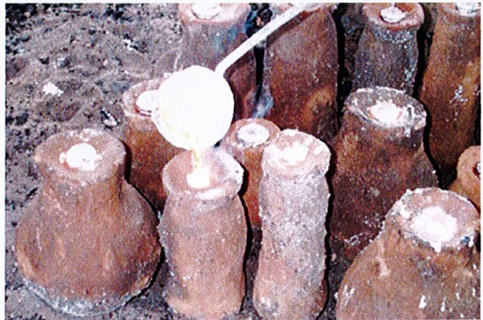
การหลอมโลหะและเทน้ำโลหะหรือการเททอง
