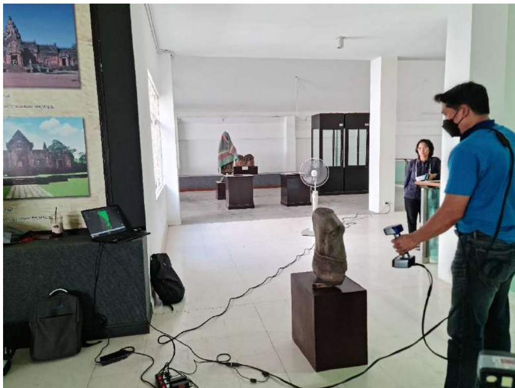
ภาพที่ 11 การเก็บรายละเอียดประติมากรรมรูปพระนางศรีชัยราชเทวีด้วย 3D Scanning
