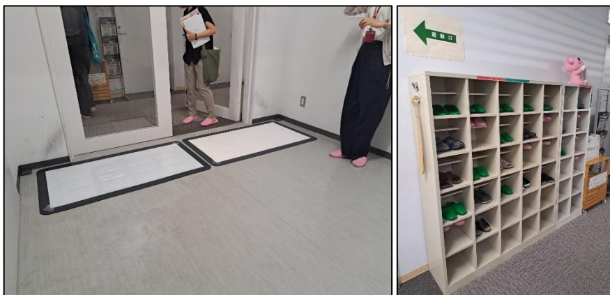
รูปที่ 12 แสดงแผ่นกาวดักฝุ่นและชั้นเปลี่ยนรองเท้า
