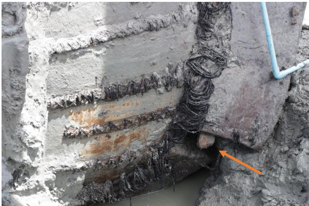
สลักไม้ซึ่งใช้เชื่อมต่อระหว่างทวนหัวเรือกับไม้กระดูกงูเรือ
