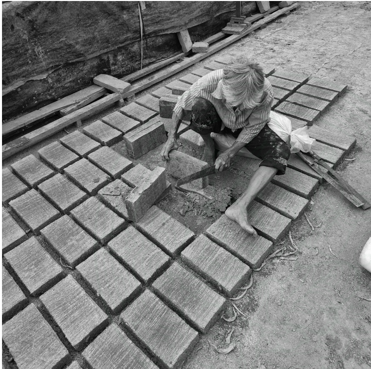
การไสแบ่งดินด้วยการ ใช้มีดปาดด้านข้างทั้ง สองด้าน
