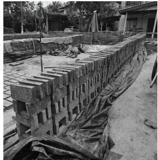
วางเรียงแต่งดินซ้อนกัน เพื่อให้แต่งดินด้านล่าง ทุกก้อนแห้งพร้อมกัน
