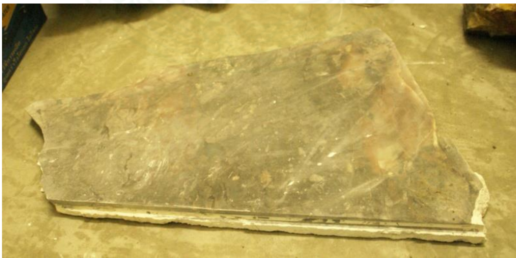
ภาพที่ ๓.๑ ซ ภาพหินสปู่ขนาด ๗๐ กิโลกรัม ตัดเป็นแผ่นตามรูปทรงธรรมชาติหนา ๑ นิ้ว
