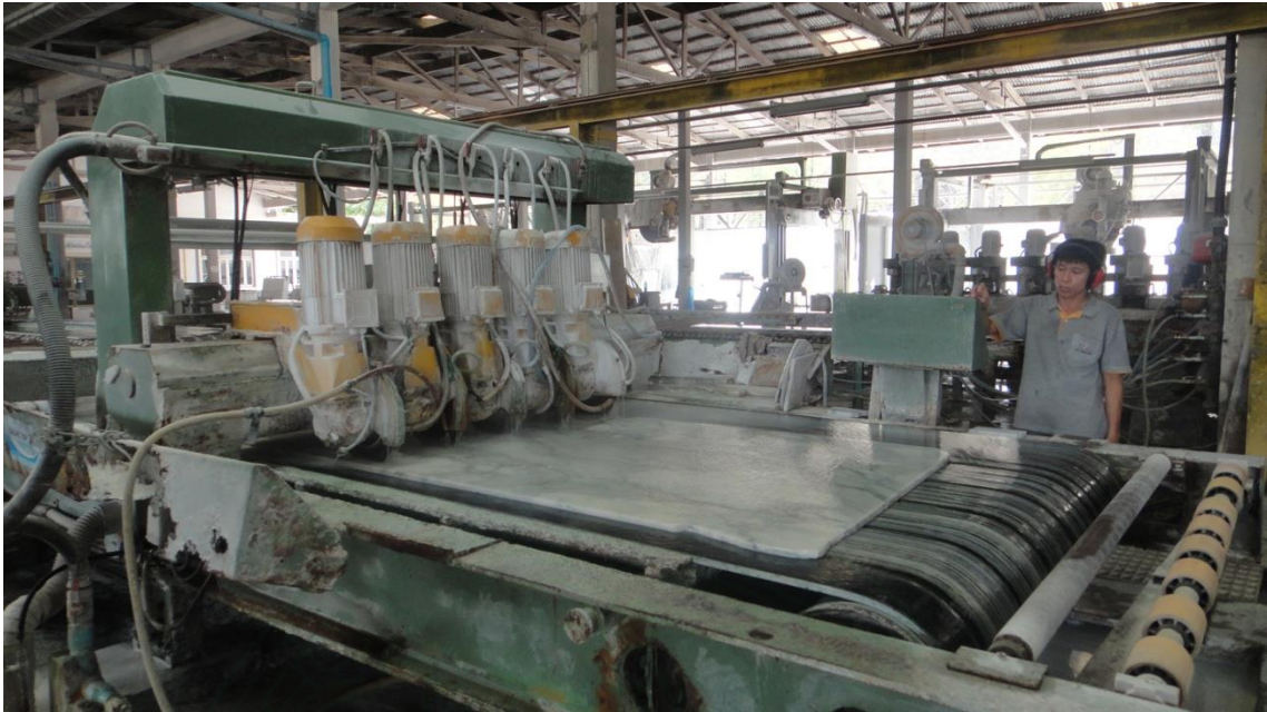
ภาพที่ ๓.๑.๓ เครื่องตัดแผ่นหินอ่อนตามแนวยาว
