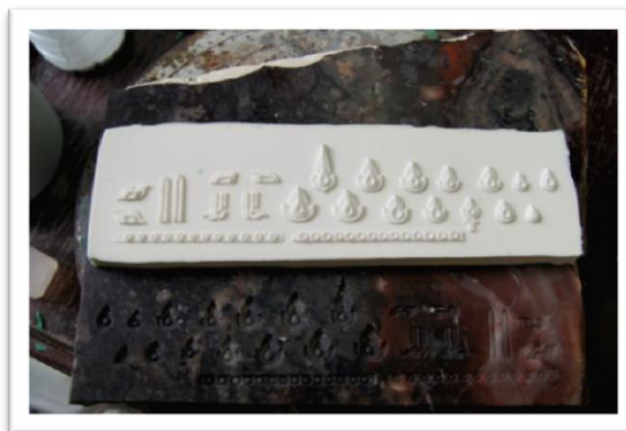
ภาพที่ ๔.๕.๑.จ การแกะยางซิลิโคนออกจากแม่พิมพ์หินสบู่
