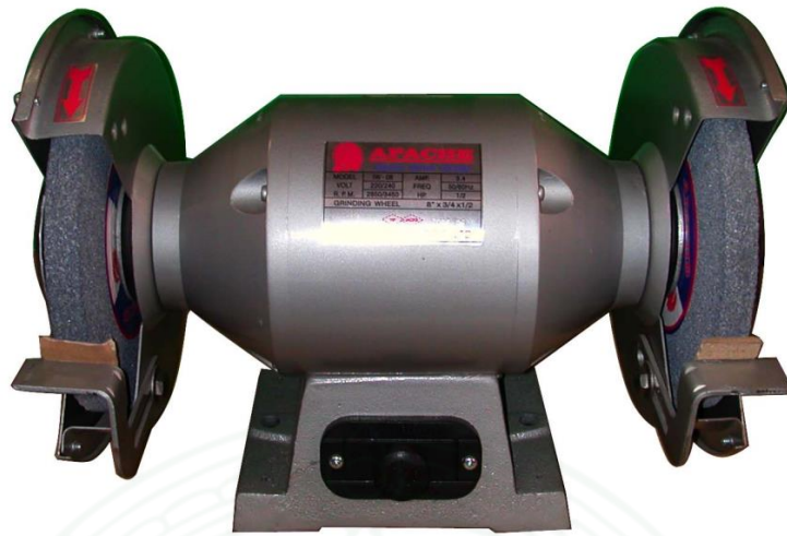
ภาพที่ ๔.๒.๒ มอเตอร์ตัดหินเจียรหรือหินขัด
