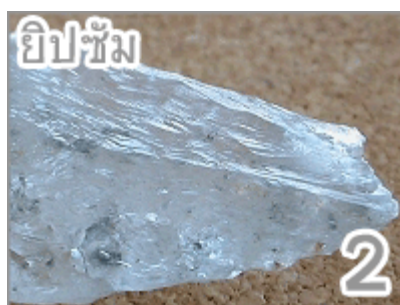
ลำดับที่ 2 ยิปซัม (Gypsum) สามารถจะขีดเป็นรอยได้บ้างด้วยเล็บมือ แต่ไม่สามารถที่จะเอายิปซัมขีดเหรียญทองแดงให้เป็นรอยได้ (เล็บมือมีความแข็งประมาณ 2.5 แต่เล็บบางคนอาจแข็งกว่า หรืออ่อนกว่านี้)
