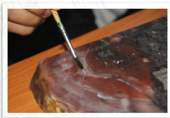
ภาพที่ ๔.๔.๒ ก ทาน้ำสบู่ลงบนแม่พิมพ์
