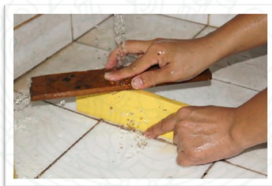
ภาพที่ ๔.๕.๓.๗ การขัดเก็บความคมของขอบแม่พิมพ์เรซิน
