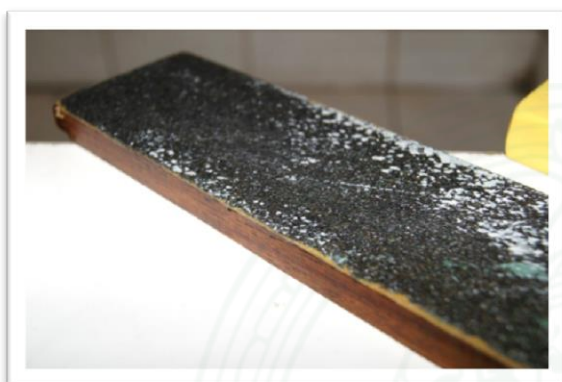
ภาพที่ ๔.๕.๓.๖ การขัดเก็บขอบแม่พิมพ์เรซินด้วยลูกหมู
