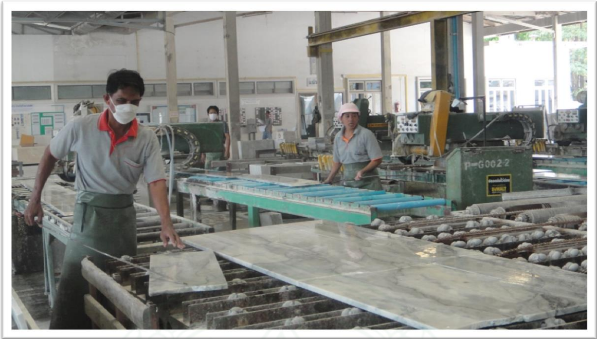
ภาพที่ ๓.๑ ฐ หินอ่อนหลังจากผ่านการตัดเครื่องตัดตามแนวยาว
