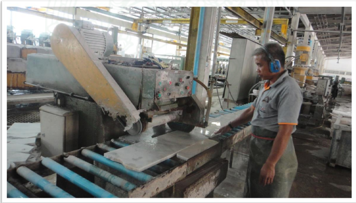
ภาพที่ ๓.๑ ฐ หินอ่อนหลังจากผ่านการตัดเครื่องตัดตามแนวยาว
