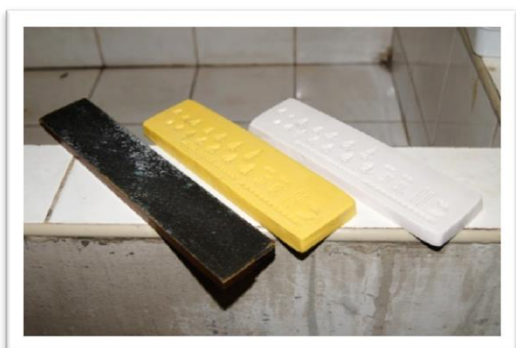
ภาพที่ ๔.๕.๓.๗ การขัดเก็บความคมของขอบแม่พิมพ์เรซิน
