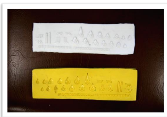
ภาพที่ ๔.๕.๓.๗ การขัดเก็บความคมของขอบแม่พิมพ์เรซิน
