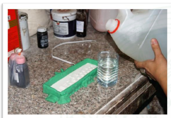
ภาพที่ ๔.๕.๒.ข การผสมเรซินชนิดหล่อและโคบอลต์สีม่วง
