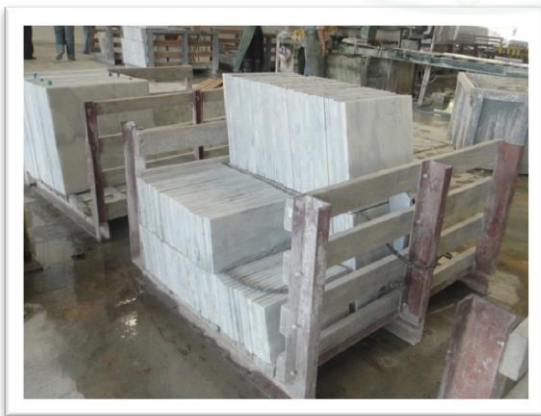
ภาพที่ ๓.๑ ๗ หินอ่อนหลังจากผ่านการตัด
