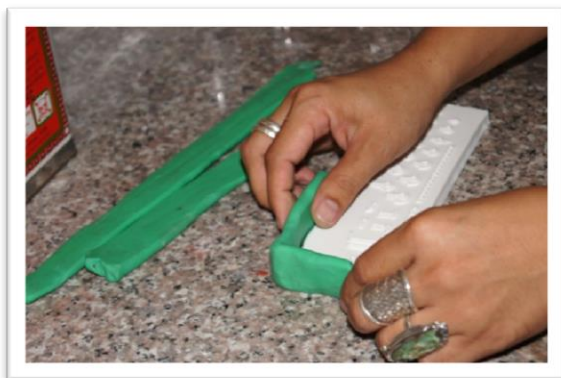
ภาพที่ ๔.๕.๒.ก การทำบล็อกดินน้ำมันในลักษณะเดียวกับการเทยางซิลิโคน
