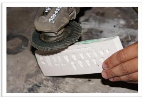
ภาพที่ ๔.๕.๓.๖ การขัดเก็บขอบแม่พิมพ์เรซินด้วยลูกหมู
