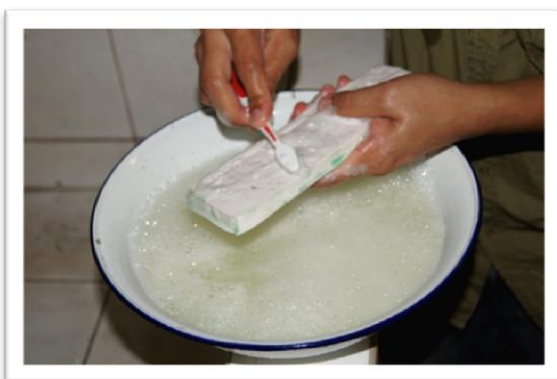
ภาพที่ ๔.๕.๓.๑ การล้างทำความสะอาดแม่พิมพ์เรซิน
