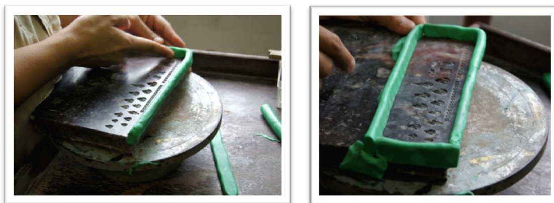
ภาพที่ ๔.๕.๑.ก การติดดินน้ำมันรอบหินสบู่
