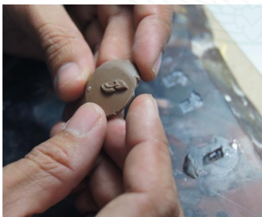
ภาพที่ ๑ ข. การตรวจสอบความลึกและความเรียบเนียนโดยใช้ดินน้ำมัน
