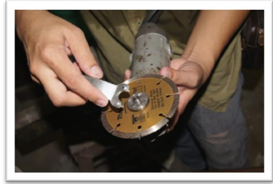
ภาพที่ ๔.๑.๑ ข การติดใบตัดกระเบื้องลงบนลูกหมู
