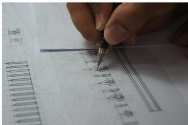
ภาพที่ ๒.๓ ข. การเขียนเส้นจริง โดยใช้อุปกรณ์เขียนแบบก่อนการเขียนแบบจริง
