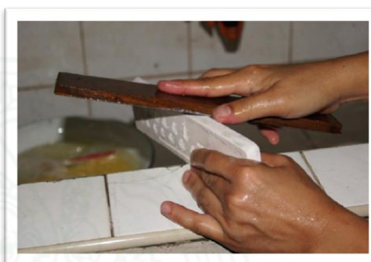
ภาพที่ ๔.๕.๓.๖ การขัดเก็บขอบแม่พิมพ์เรซินด้วยลูกหมู
