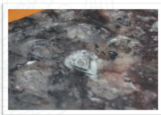
ภาพที่ ๔.๔.๑ ก ทาน้ำสบู่ลงบนแม่พิมพ์
