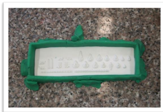
ภาพที่ ๔.๕.๒.ก การทำบล็อกดินน้ำมันในลักษณะเดียวกับการเทยางซิลิโคน
