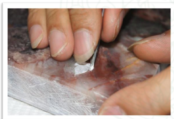
ภาพที่ ๔.๓.๓ ก การเก็บขอบด้านข้างตัวลายและทดสอบด้วยดินน้ำมัน
