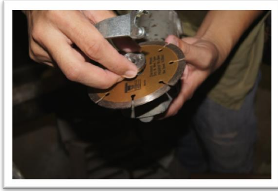
ภาพที่ ๔.๑.๑ ข การติดใบตัดกระเบื้องลงบนลูกหมู
