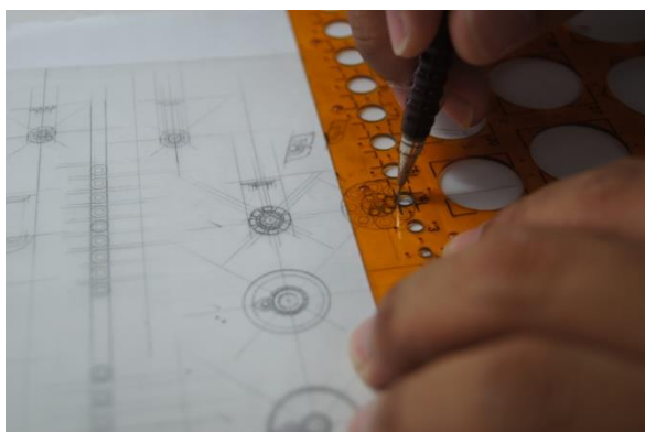
ภาพที่ ๒.๓ ก. การเขียนเส้นร่าง โดยใช้อุปกรณ์เขียนแบบก่อนการเขียนแบบจริง
