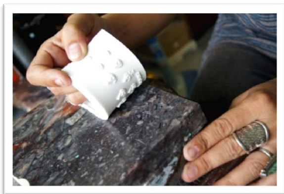
ภาพที่ ๔.๕.๑.จ การแกะยางซิลิโคนออกจากแม่พิมพ์หินสบู่
