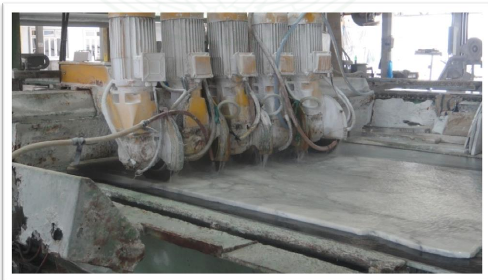
ภาพที่ ๓.๑ ฉ ภาพการทำงานของเครื่องตัดหินอ่อนตามแนวยาว
