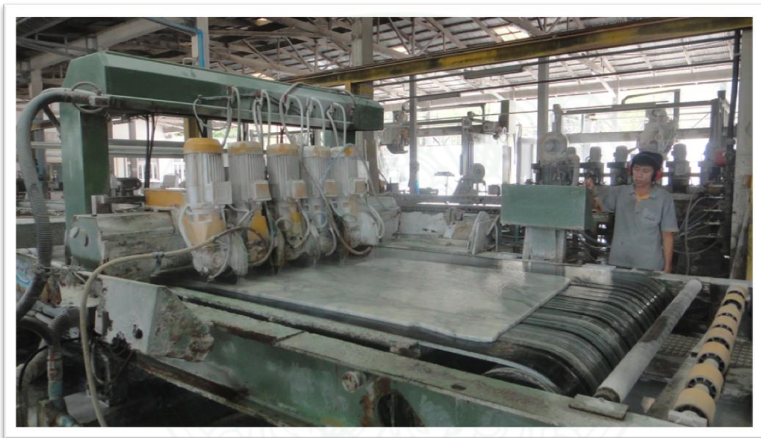
ภาพที่ ๓.๑ ฉ เครื่องตัดแผ่นหินอ่อนตามแนวยาว
