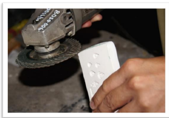
ภาพที่ ๔.๕.๓.๖ การขัดเก็บขอบแม่พิมพ์เรซินด้วยลูกหมู
