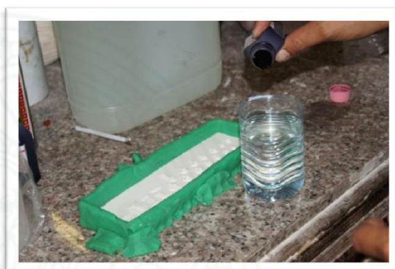
ภาพที่ ๔.๕.๒.ข การผสมเรซินชนิดหล่อและโคบอลต์สีม่วง
