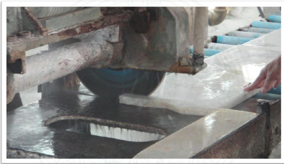
ภาพที่ ๓.๑ ฐ การทำงานเครื่องตัดหินอ่อนขนาดเล็ก
