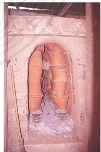
กระถางและเครื่องปั้นที่เผาสุกแล้วในเตาจีนพร้อมที่จะนำออกจากประตูเตา
