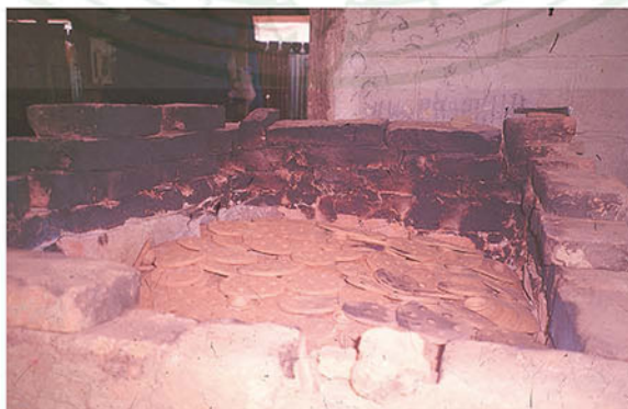
การเผาเครื่องปั้นดินเผาในเตาถังโดยใช้เศษกระเบื้องปิดคลุมขณะเผา
